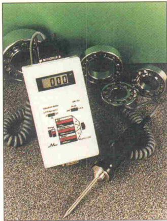
Bild 2. Monitran VM110 – Schwingungstest im Service.
