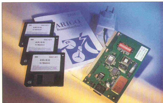
Bild 3: Adapter und Software für die PC-Steuerung. Die Karte paßt in einen 8- oder 16-Bit-Steckplatz – je nach Interrupt.
